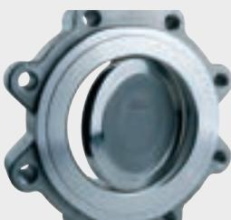
Die Klappe in ANFLANSCHAUSFÜHRUNG verfügt serienmäßig über einen verschraubten Sitzhalterring, während die Ausführung mit ZWISCHENFLANSCH einen glatten Sitzhalterring aufweist. Je nach Anwendungsanforderung können sämtliche Bauarten mit geklemmten oder geschraubten Sitzhalterringen mit glatter Flanschfläche zur Gewährleistung beidseitig blasendichten Abschlusses in beiden Durchflussrichtungen oder mit normalen verschraubten Sitzhalterringen ausgestattet werden.
