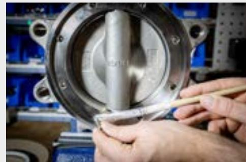
21. Die Schrauben (7) in die passenden Bohrungen einführen.
