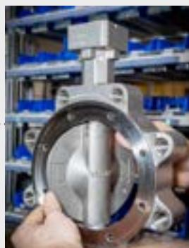
9. Den Schaft (3) leicht einfetten und durch Gehäuse (1), Scheibe (2) und Scheibenzentrierringe (8) führen; an den Bohrungen für die Kegelstifte ausrichten (Kegelstiftausrichtung beachten!).
