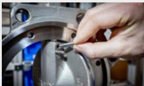
11. Mit einem Hammer fest einklopfen und mit einem Körnerschlag dauerhaft sichern.
