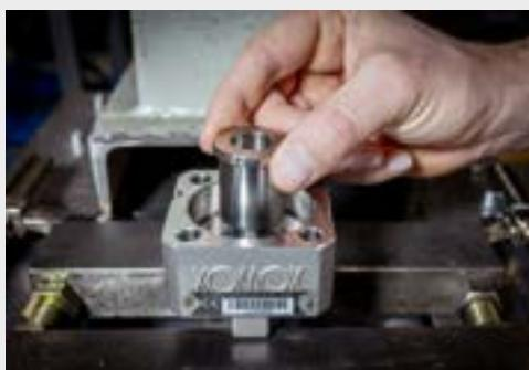
15. Die Tellerfedern (13) gemäß beiliegender Zeichnung einsetzen.
