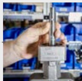
10. Die Kegelstifte (4) einführen. Diese müssen sich über mindestens zwei Drittel der Länge ohne Kraftaufwand einschieben lassen. Andernfalls die Ausrichtung der Konusbohrungen überprüfen.
