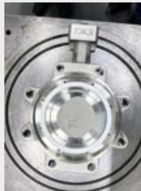
21. Den Sitzhaltering (6) mit flachen Seite nach außen einsetzen und einpressen; Presskraft beibehalten.
