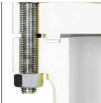
**5. Deckelflansch in Nut- und Feder-Verbindung;** Durchgangsschrauben aus 1.7225 / A 320 Grade L7M und Muttern aus 1.7218 / A 194 Grade 7M; Deckeldichtung mit PTFE Auflage
