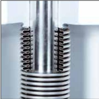
**4. Mehrwandiger, vollumspülter Faltenbalg aus Edelstahl,** gegen Verdrehen gesichert, ausgelegt für 10.000 Lastwechsel; vollständig verschweiß
