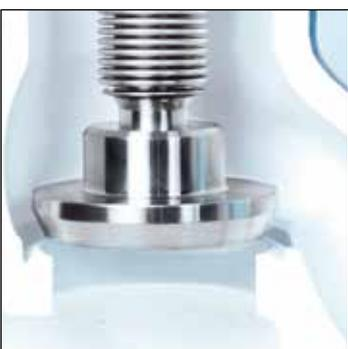
**6. Drehbar gelagerter** Ventilkegel mit **konischer Dichtleiste** aus gehärtetem Chromstahl 1.4021/AISI 420 bzw. gepanzert mit Stellite® 6; Gehäusesitz gepanzert mit Edelstahl 1.4370/AIS 307 bzw. Stellite® 21
