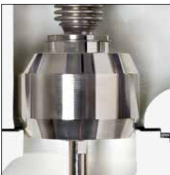
**6. Ventilkegel mit zweiseitig-konischer Dichtleiste aus gehärtetem Chromstahl 1.4021 / AISI 420 oder gepanzert mit Stellite® 6; Gehäusesitz gepanzert mit 1.4370 / AISI 307 oder Stellite® 21**
