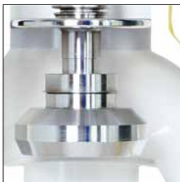
**6. Drehbar gelagerter Ventilkegel mit konischer Dichtleiste, gepanzert mit Stellite® 6; Gehäuse-sitz gepanzert mit Stellite® 21**
