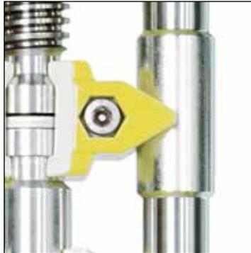
**2. Sicherheitsstopfbuchspackung** aus PTFE-Seide; Stopfbuchsbrille mit doppelter O-Ring-Abdichtung zur Verhinderung von Feuchtigkeitseintritt
