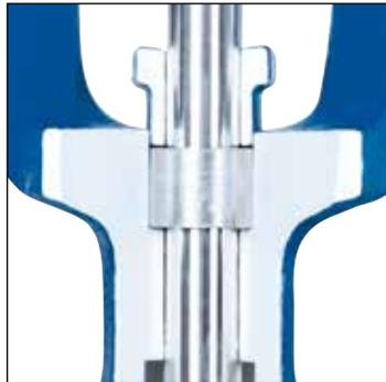
**3.** **Metallische Rückdichtung** mit Hubbegrenzung in Offenstellung und Faltenbalg-Schwingungsdämpfung
