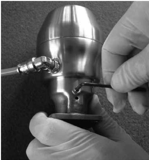
16. Antriebsaufsatz drehen, bis das Entlüftungsloch mit der Verriegelungsschraube des Spindeladapters fluchtet.
