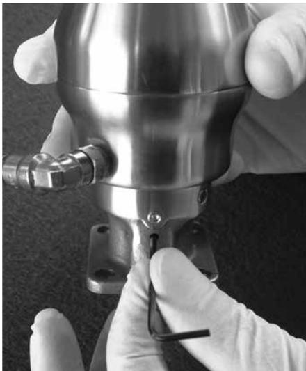
18. Nach dem Lösen der Verriegelungsschraube des Spindeladapters den Spindeladapter und die Druckstückbaugruppe von dem Antriebsaufsatz entfernen.
