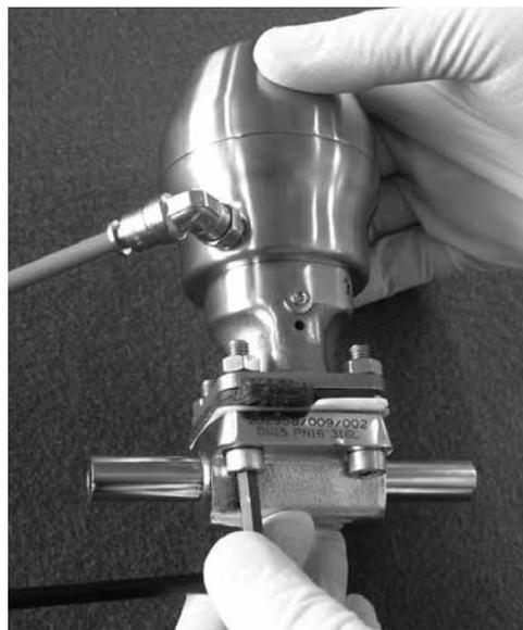
2. Befestigungselemente und den Ventilantrieb entfernen.
