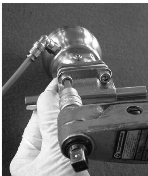
Dadurch wird gewährleistet, dass die Membran sich richtig zentriert, bevor die Schrauben entgültig angezogen werden.
