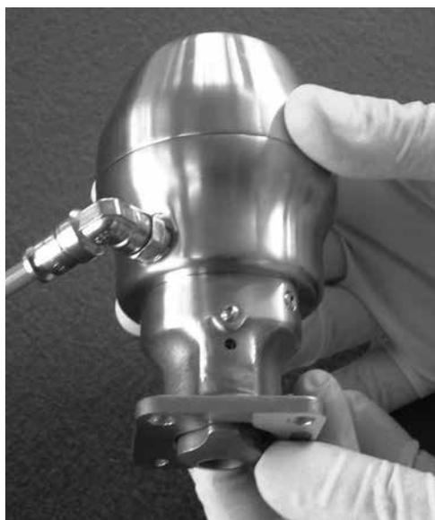
21. Inbusschlüssel in Entlüftungsloch einführen und Verriegelungsschraube des Spindeladapters vollständig festdrehen (untenstehende Tabelle 1 beachten).
