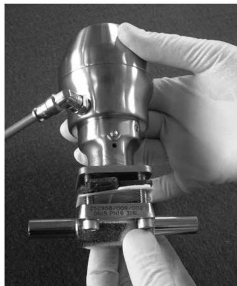
3. Zustand der Dichtflächen des Ventilgehäuses (Membranflansch/Wehrsteg) auf Schäden prüfen.
