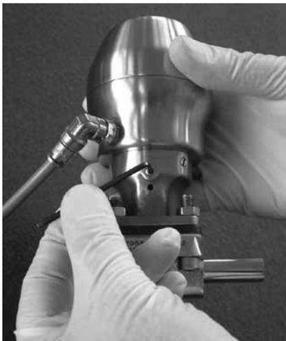
25. Antriebszylinder bei aufgebautem Antrieb drehen, bis die Einlassöffnung korrekt ausgerichtet ist. Mit Drehfunktion ist der Antrieb in den Größen DN15 (0.5 in.) - DN50 (2.00 in.) erhältlich. Vergewissern Sie sich bitte, dass federschließende Antriebe mit Druckluft beaufschlagt und federöffnende Antriebe drucklos beim Ausrichtvorgang sind.
