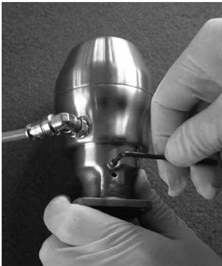
23. Den Antrieb wieder am Ventilgehäuse befestigen. Schritte 6 bis 14 wiederholen.
