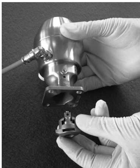
20. Loctite 222 auf die Verriegelungsschraube des Spindeladapters auftragen. Spindeladapter und neue Druckstückbaugruppe in Antriebsaufsatz einsetzen.
