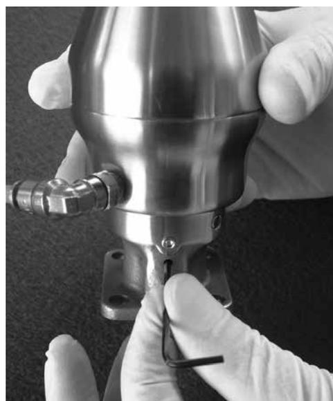
22. Antriebskopf/Luftanschlüsse in gewünschte Position drehen und Madenschraube langsam festdrehen, bis der Antriebsaufsatz befestigt ist (untenstehende Tabelle 2 beachten).
