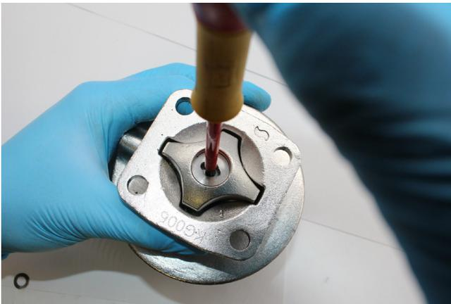
**18.** Assemblez le sous-ensemble adaptateur de broche/ compresseur de remplacement sur la broche principale de l'actionneur à l'aide d'un tournevis à tête plate.
