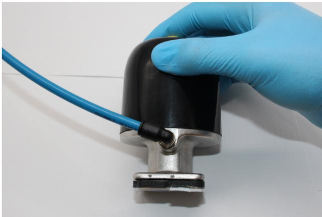
Engagez la baïonnette de la membrane dans la fente du compresseur en appliquant une pression au centre de la membrane. Assurez-vous que l'engagement est correct et continuez à appliquer une pression au centre de la membrane en tournant sur 90°
