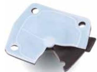
Membran in zweiteiliger Konstruktion – PTFE-Beschichtung mit rückseitiger Gummimembran zur Erhöhung der Druckfestigkeit und Haltbarkeit.
