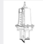
**ESM/ES-Antriebe (federschließend/ federöffnend/doppeltwirkend)**
