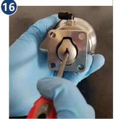
将螺丝刀啮合到主轴适配器插槽。
