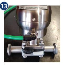
从执行机构上释放气压(仅适用 于"NC"执行机构)
