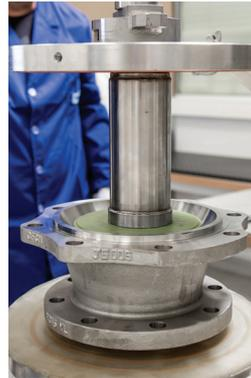
17. Den zweiten Dichtring (Pos. 40) auf den Sitz „B“ (Pos. 6) aufziehen und anschließend beide gemeinsam in das Gehäuse (Pos. 1) einsetzen und auf den S-Ring (Pos. 42) aufschieben. Die Dichtflächen des Sitzes (Pos. 6) einfetten. Zum Vorkomprimieren der Sitzdichtung die in Tabelle B angegebenen Werte der Axialkraft genau wie auf der Seite des Deckels aufbringen.
