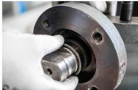
5. Kontaktflächen der Führungsbuchse (Pos. 14) und der Stopfbuchse (Pos. 8) schmieren, dann auf die Schaltwelle setzen und die Schaltwellendichtungen tiefer in den Schaltwellenraum drücken.
