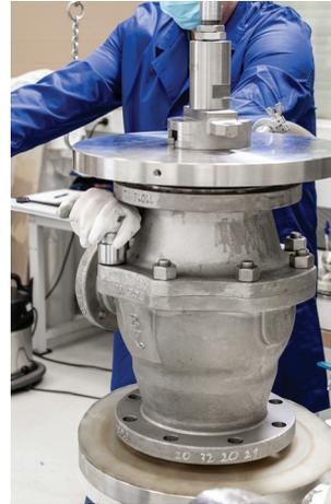
20. Gehäuse (Pos. 1) und Gehäusedeckel (Pos. 2) zusammenfügen (Beschriftung auf den Hälften zeigt in dieselbe Richtung). Die Muttern (Pos. 11) in der in Abbildung 7 dargestellten Reihenfolge anziehen.
