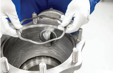
14. S-Ring (Pos. 42) über die Wellenfeder (Pos. 41) in das Gehäuseteil (Pos. 1) einsetzen. Ausrichtung des S-Rings wie in Abb. 7 beibehalten.
