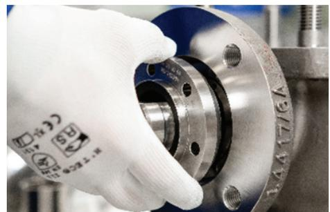
12. Schritte 6, 7, 8, 9 und 10 wiederholen, bis 4 Packungsringe übereinander gestapelt sind; abwechselnd 2 „Graphit-Packungsringe (dick)“ und 2 „Metallringeinlage als Diffusionssperre“ (dünn) einsetzen.
