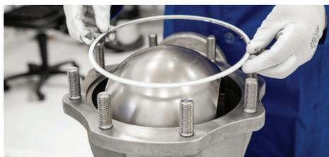
21. Gehäuse (Pos. 1) und Gehäusedeckel (Pos. 2) zusammenfügen (Beschriftung auf den Hälften zeigt in dieselbe Richtung). Die Muttern (Pos. 11) in der in Abbildung 7 dargestellten Reihenfolge anziehen.
