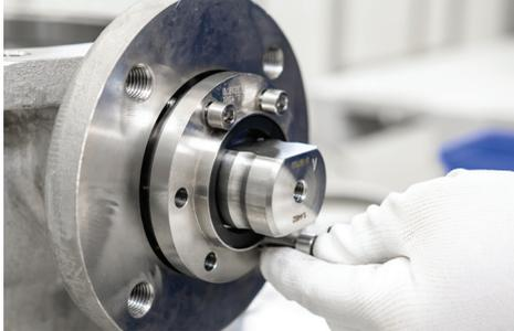
7. Die Packungen auf das für den Zusammenbau erforderliche Verhältnis komprimieren; dann die Schrauben schrittweise auf das in der Tabelle auf Seite 9 oder 10 angegebene Drehmoment anziehen.
