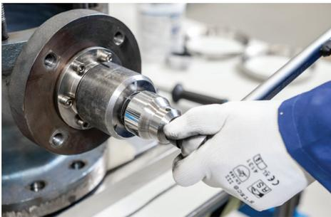
9. Die Stopfbuchse zusammen mit dem Stopfbuchsenrohr entfernen.
