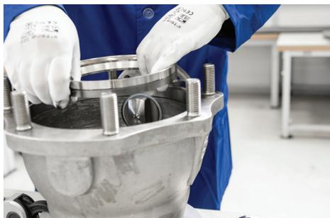
16. Dichtring (Pos. 40) auf Sitz „B“ (Pos. 6) aufziehen und anschließend beide gemeinsam in Gehäusedeckel (Pos. 2) einsetzen. Die Dichtflächen des Sitzes (Pos. 6) einfetten. Zum Vorkomprimieren der Sitzdichtung die in Tabelle B angegebenen Werte der Axialkraft aufbringen.
