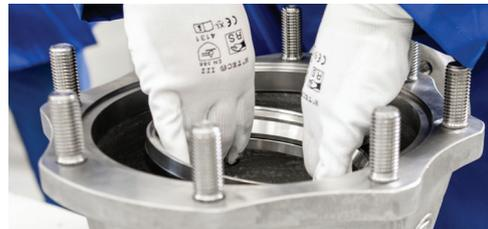
18. Die Kugel (Pos. 3) in das Innere des Gehäuses (Pos. 1) mit der Durchgangsöffnung in Geschlossenstellung einführen. (darauf achten, dass Schaltwelle in die vorgesehene Ausfräsung in der Schaltkugel eingelassen wird, wie in der Montagezeichnung gezeigt nach ISO 5211)
