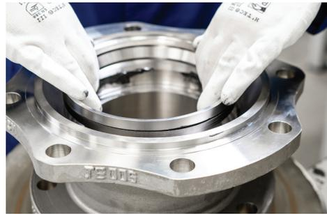
17. Sitz „A“ (Pos. 6) mit einer Presse einpressen, um die Sitzdichtung vorzukomprimieren. Zum Schutz des Sitzes einen Abstandshalter aus Kunststoff verwenden und den vorgeschriebenen Druck ausüben. Falls keine Presse zur Verfügung steht, wenden Sie sich an KROMBACH bezüglich alternativer Möglichkeiten.
