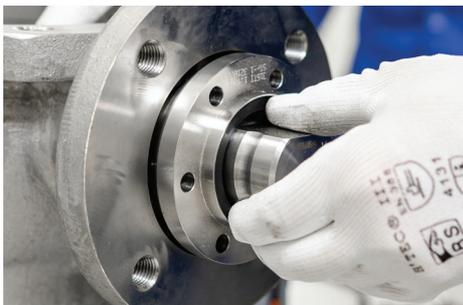
8. „Castrol Optimol Paste TA“ auf die Schrauben (Pos. 21) auftragen und in die Stopfbuchse einsetzen. Schrauben von Hand leicht vorspannen.
