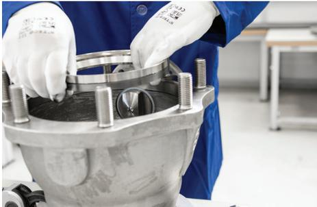
15. Dichtring (Pos. 40) auf Sitz „B“ (Pos. 6) aufziehen und anschließend beide gemeinsam in den Gehäusedeckel (Pos. 2) einsetzen. Die Dichtflächen des Sitzes (Pos. 6) einfetten. Zum Vorkomprimieren der Sitzdichtung die in Tabelle B angegebenen Werte der Axialkraft aufbringen.
