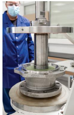
18. Den zweiten Dichtring (Pos. 40) auf den Sitz „A“ (Pos. 6) aufziehen und anschließend beide gemeinsam in das Gehäuse (Pos. 1) einsetzen und auf den S-Ring (Pos. 42) aufschieben. Die Dichtflächen des Sitzes (Pos. 6) einfetten. Zum Vorkomprimieren der Sitzdichtung die in Tabelle B angegebenen Werte der Axialkraft genau wie auf der Seite des Deckels aufbringen.
