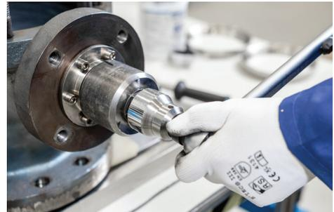
11. Die Stopfbuchse zusammen mit der Führungsbuchse entfernen.
