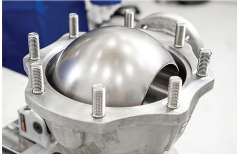
20. Die Gehäusedichtung (Pos. 5) in die Gehäusenut einsetzen.
