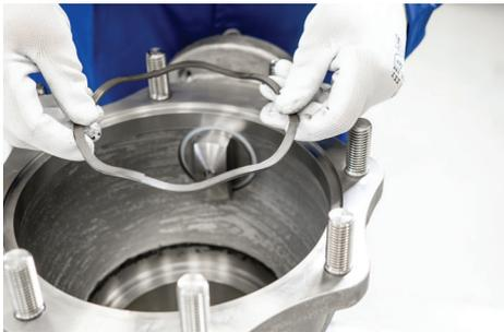
15. S-Ring (Pos. 42) über die Wellenfeder (Pos. 41) in das Gehäuseteil (Pos. 1) einsetzen. Ausrichtung des S-Rings wie in Abb. 6 beibehalten.
