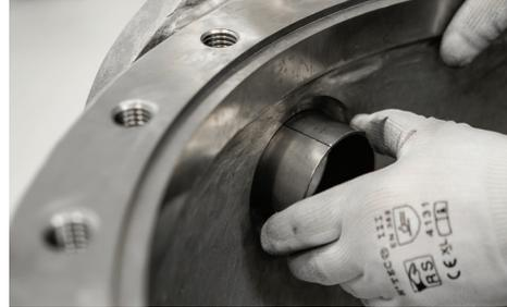
4. Einen „Graphit-Packungsring (dick)“ mit „Metallringeinlage als Diffusionssperre“ (dünn) (Pos. 13) über die Schaltwelle (Pos. 4) schieben.
