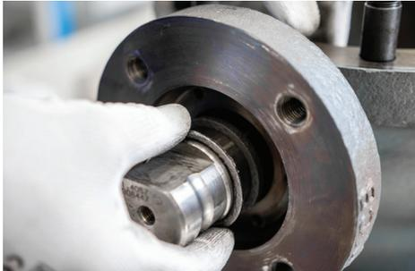
7. Kontaktflächen der Führungsbuchse (Pos. 14) und der Stopfbuchse (Pos. 8) schmieren, dann auf die Schaltwelle setzen und die Schaltwellendichtungen tiefer in den Schaltwellenraum drücken.
