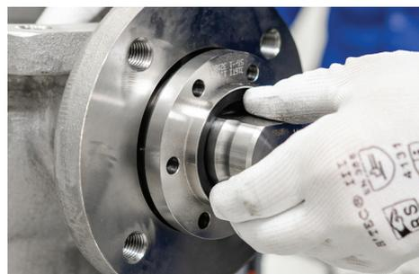
6. „Castrol Optimol Paste TA“ auf die Schrauben auftragen und in die Stopfbuchse einsetzen. Schrauben von Hand
