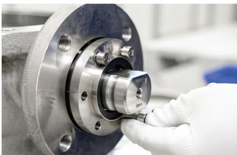
9. Die Packungen auf das für den Zusammenbau erforderliche Verhältnis komprimieren; dann die Schrauben schrittweise auf das in der Tabelle auf Seite 9 oder 10 angegebene Drehmoment anziehen.
