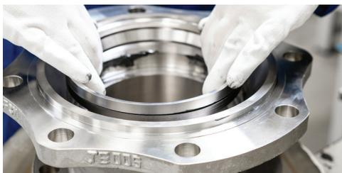
16. Sitz „B“ (Pos. 6) mit einer Presse einpressen, um die Sitzdichtung vorzukomprimieren. Zum Schutz des Sitzes einen Abstandshalter aus Kunststoff verwenden und den vorgeschriebenen Druck ausüben. Falls keine Presse zur Verfügung steht, wenden Sie sich an KROMBACH bezüglich Alternativen.
