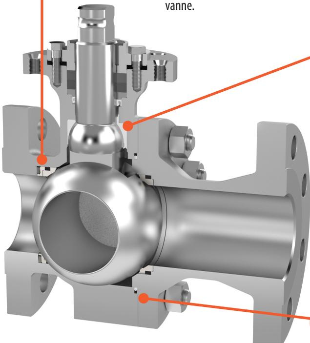
En alternative, pour les applications à plus haute température, Krombach propose une garniture en graphite avec des anneaux de barrière de diffusion métalliques pour assurer les plus hauts niveaux de confinement des émissions fugitives sans sacrifier le **FONCTIONNEMENT À FAIBLE COUPLE** et la protection anti-feu.
