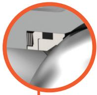
Hochpräzises Läppverfahren beim Bearbeiten der Oberflächen von Metallkugel und -sitz sorgt für hohe Dichtwirkung und gewährleistet auch bei niedrigem Druck eine **LECKAGEFREIE ABDICHTUNG**. Zudem erzeugt die Sitzgeometrie einen Selbstreinigungseffekt, während die Sitzfedern die Einflüsse der Wärmedehnung ausgleichen und dadurch ein **KONSTANT NIEDRIGES DREHMOMENT** sicherstellen.
