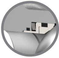
Optionale Ausstattung der Sitze mit Graphit-Abstreifringen bei Anwendungen mit starker abrasiver Belastung, bei der Katalyse in Raffinerieprozessen sowie der Förderung von Schlämmen und anderer viskosen Flüssigkeiten zum Schutz innenliegender Bauteile vor der Gefahr durch Festfressen und zur **VERLÄNGERUNG DER LEBENSDAUER** der Armatur.
