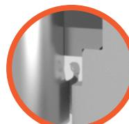
二级独立的弹簧加载唇形密封可补偿任何磨损、加工公差或偏心，并提供阀杆密封的动态加载，以**延长填料系统的使用寿命**。
