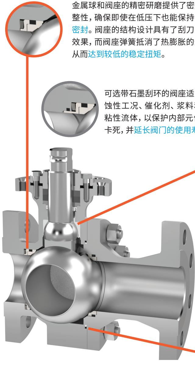
金属球和阀座的精密研磨提供了密封的完整性，确保即使在低压下也能保持**紧密的密封**。阀座的结构设计具有了刮刀自清洁效果，而阀座弹簧抵消了热膨胀的影响，从而**达到较低的稳定扭矩**。
