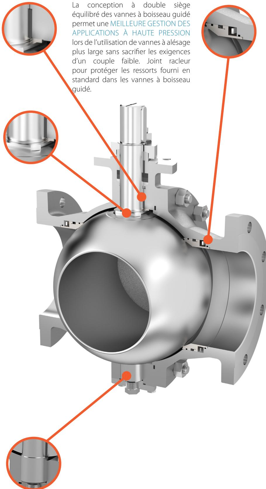
L'arbre inférieur est supporté par des roulements protégés du fluide pour assurer un alignement adéquat et **MAINTENIR LES EXIGENCES DE COUPLE FAIBLE.**
