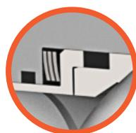
Le rodage de précision du boisseau sphérique et du siège en métal assure l'intégrité de l'étanchéité, garantissant une **ÉTANCHÉITÉ PARFAITE**, même à basse pression. La géométrie du siège crée un effet d'auto-nettoyage par racleur. Les ressorts du siège compensent les effets de la dilatation thermique pour un **COUPLE CONSTANT PLUS FAIBLE**.
