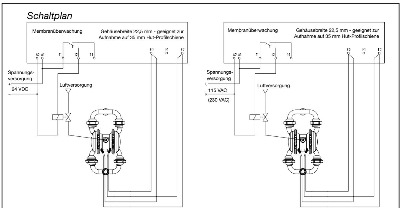
Abb. 6: Schaltplan Leckagesensoren
