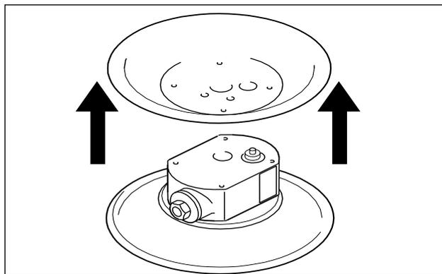
Abb. 12: Demontage der Luftkammern (entfällt bei Steuerblöcken mit integrierter Luftkammer)
