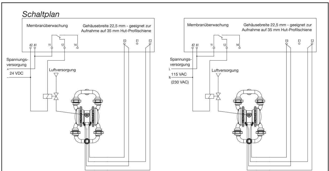
Abb. 6: Schaltplan Leckagesensoren
